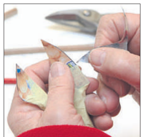
Blechfeder aufbiegen – damit die Tinte schön fließen kann.
