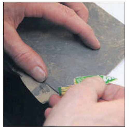
Kanten schleifen – für den schwungvollen Strich und ein sauberes Schriftbild.
