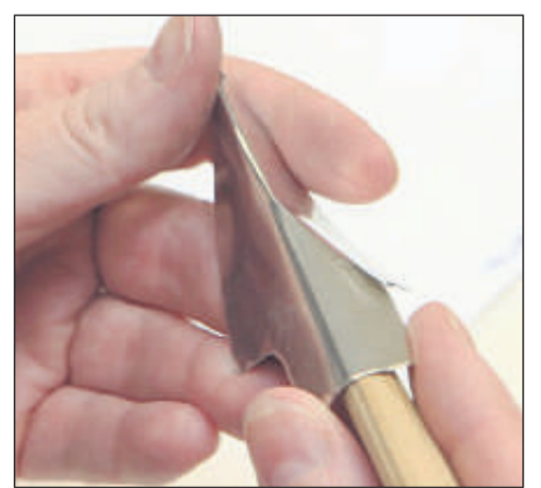
Und zum Schluss das Federblech biegen, auf einen Bambusstock setzen – und fertig ist die Cola-Feder.
